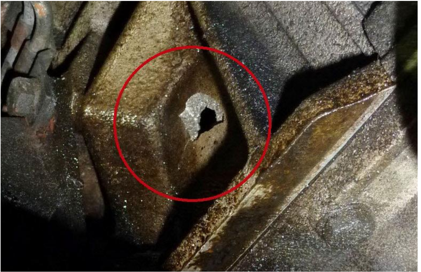
Motorblock Ansicht von unten – Pleuel durchschlägt Motorblock
